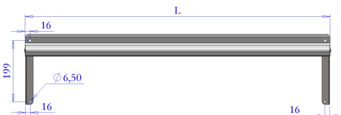
Etagère en tôle d'INOX AISI 304L épaisseur 15/10èmes à bord avant avec un rayon de 20 mm, avec dosseret arrière d'une hauteur de 36 mm rayonné de 10 mm à sa base
